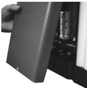
3. Retirez le panneau frontal en le faisant basculer vers l'extérieur et vers le bas.
